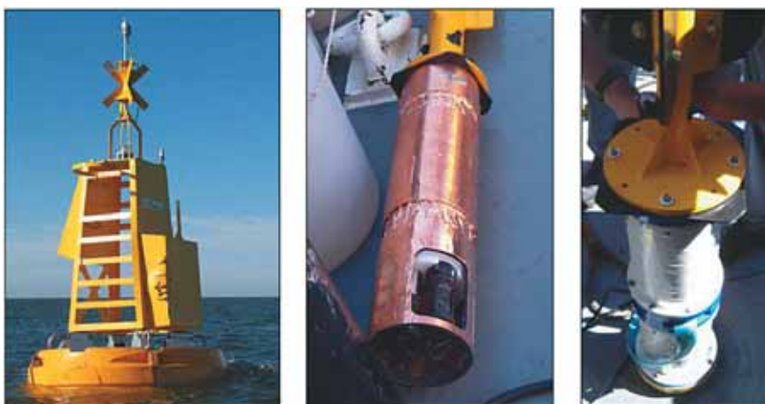
Figura 4. Boya oceanográfica con la estación meteorológica en la parte superior (panel izquierdo), equipo SMATCH de medición oceanográfica (panel central) y ADCP (panel derecho).
