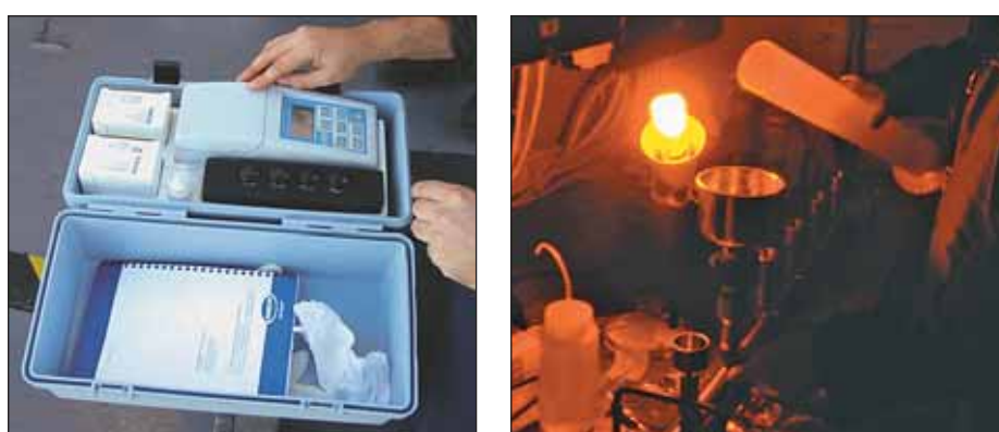
Figura 7. Análisis de turbidez con un equipo marca Hach (izquierda) y filtrado in situ de muestras de agua para el análisis del contenido de clorofila (derecha).
